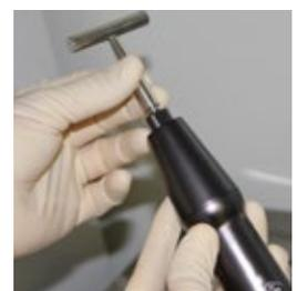
complètement immergés) à une température comprise entre 45°C et 55°C (113 - 131°F). Diluer la solution nettoyante selon les instructions du fabricant. Pomper 15 fois à l'aide de la clef de nettoyage.
